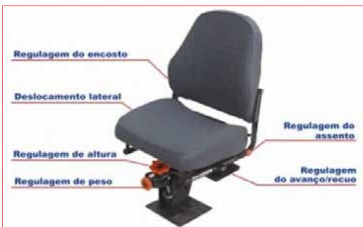
Motorista, é preciso ter cuidado para ajustar sua cadeira no ônibus. Para evitar que elas quebrem, levante do assento e faça a regulagem. Desta maneira, o procedimento vai ser realizado sem força e sem danificar o equipamento. Garantindo uma boa postura durante o trabalho.
